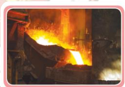
ภาพที่ 2.9 ลักษณะของเตาเบสซเมเมอร์
