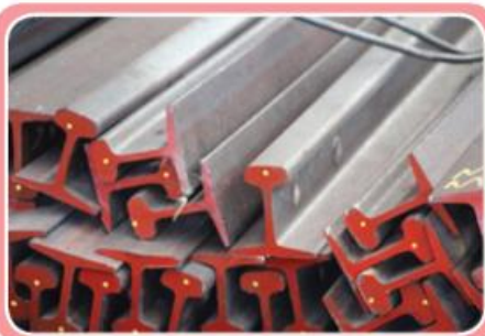
ภาพที่ 3.4 รางรถไฟทำจากเหล็กกล้าคาร์บอนปานกลาง
