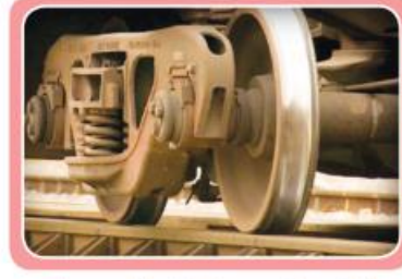
ภาพที่ 3.16 ล้อรถไฟทำจากเหล็กหล่อสีขาว
