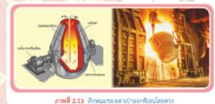
ภาพที่ 2.13 ลักษณะของเตาเป่าออกซิเจนโดยตรง
