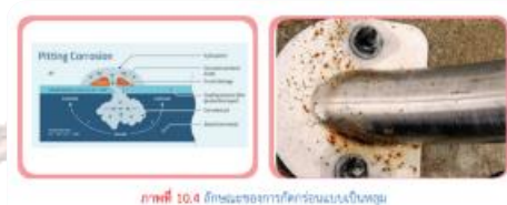
ภาพที่ 10.4 ลักษณะของการกัดกร่อนแบบเป็นหลุม
