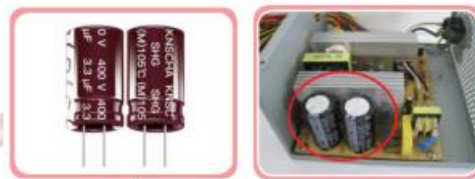
ภาพที่ 9.21 ตัวเก็บประจุ และการใช้งานวงจรไฟฟ้า
