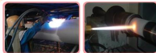
ภาพที่ 10.10 ลักษณะการพ่นโลหะเหลวเคลือบผิว
