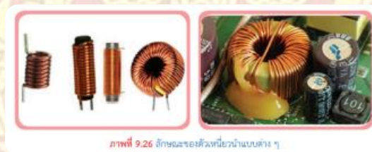
ภาพที่ 9.26 ลักษณะของตัวเหนี่ยวนำแบบต่าง ๆ
