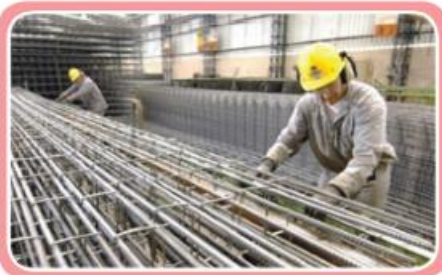
ภาพที่ 3.1 เหล็กเส้นในอุตสาหกรรมก่อสร้าง ทำจากเหล็กกล้าคาร์บอนต่ำ
