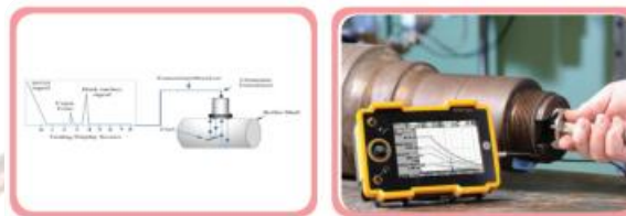
ภาพที่ 11.4 การตรวจสอบด้วยคลื่นอัลตราโซนิก
