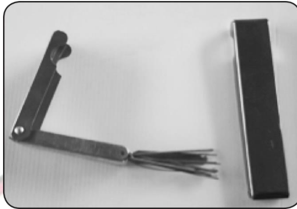
แสดงลักษณะอุปกรณ์ทำความสะอาดหัวทิฟเชื่อม
