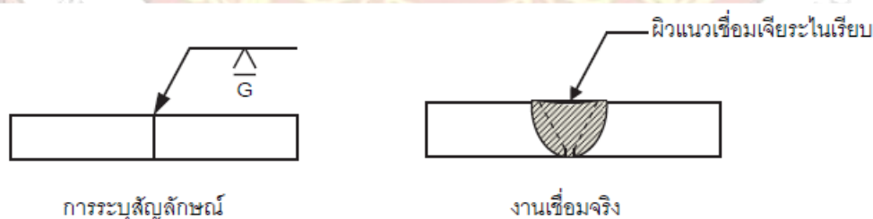
รูปที่ ๔.๒๕ การกำหนดสัญลักษณ์การตกแต่งผิวงานเชื่อมงานต่อ
