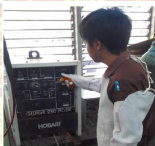
รูปที่ ๒.๑๖ แสดงการปิดเครื่องเชื่อมทุกครั้งเมื่อปฏิบัติงานเสร็จ
