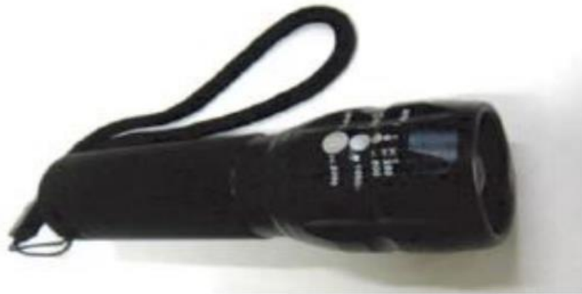
รูปที่ ๒. ๑๔ แสดงลักษณะไฟฉายสำหรับใช้ตรวจสอบงานเชื่อม
