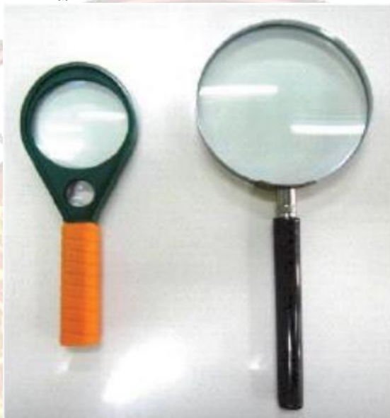
รูปที่ ๒. ๑๓ แสดงลักษณะแว่นขยายสำหรับใช้ตรวจสอบงานเชื่อม
