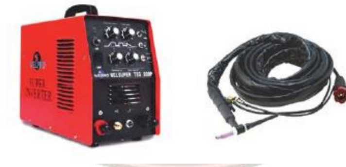
ภาพที่ ๑.๔ แสดงลักษณะเครื่องเชื่อมงานเชื่อมอาร์กทั้งสแตนเลสกลุ่มแบบ Inverter
