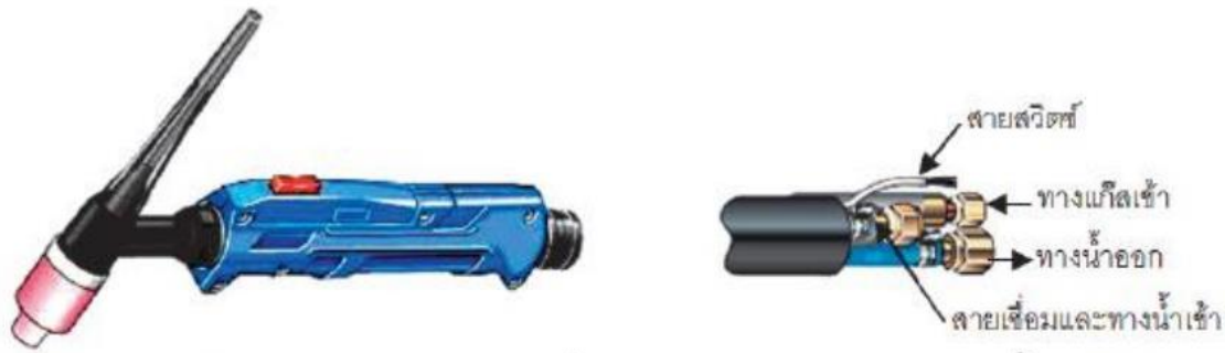
ภาพที่ ๑.๙ แสดงลักษณะหัวเชื่อมชนิดระบายความร้อนด้วยน้ำ
