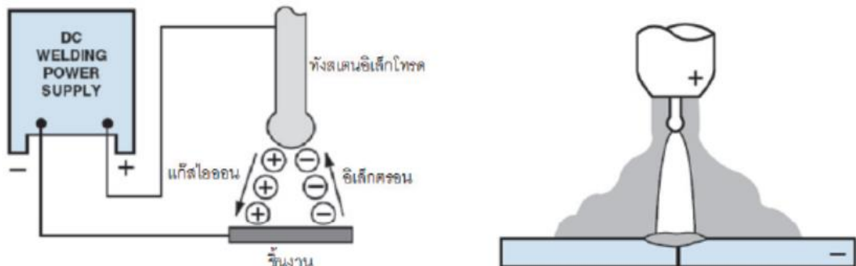
รูปที่1.15 แสดงระบบวงจรของกระแสไฟเชื่อมชนิดกระแสตรงขั้วกลับ (DCEP)
