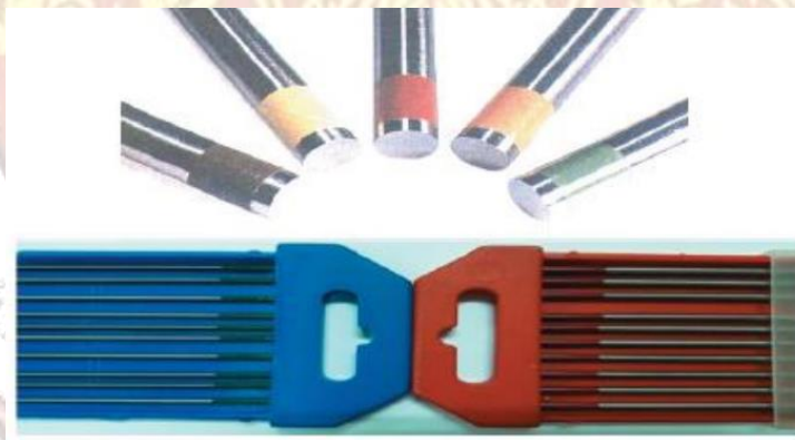
ภาพที่ ๑.๑๒ แสดงลักษณะรูปทรงและต าแหน่งแสดงโค้ดสีของทังสแตนอิเล็กโทรด
