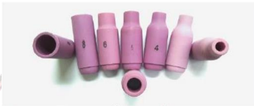
ภาพที่ ๑.๘ แสดงลักษณะหัวฉีดที่ใช้กับงานเชื่อมอาร์กทั้งสแตนเลสสตีล
