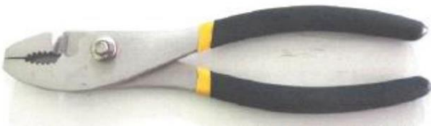
รูปที่ ๒.๔ แสดงลักษณะคีมจับชิ้นงานเชื่อม
