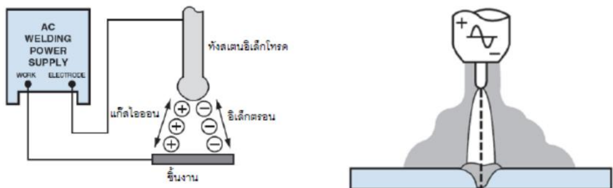
รูปที่ 1.13 แสดงระบบวงจรของกระแสไฟเชื่อมชนิดกระแสสลับความถี่สูง (ACHF)
