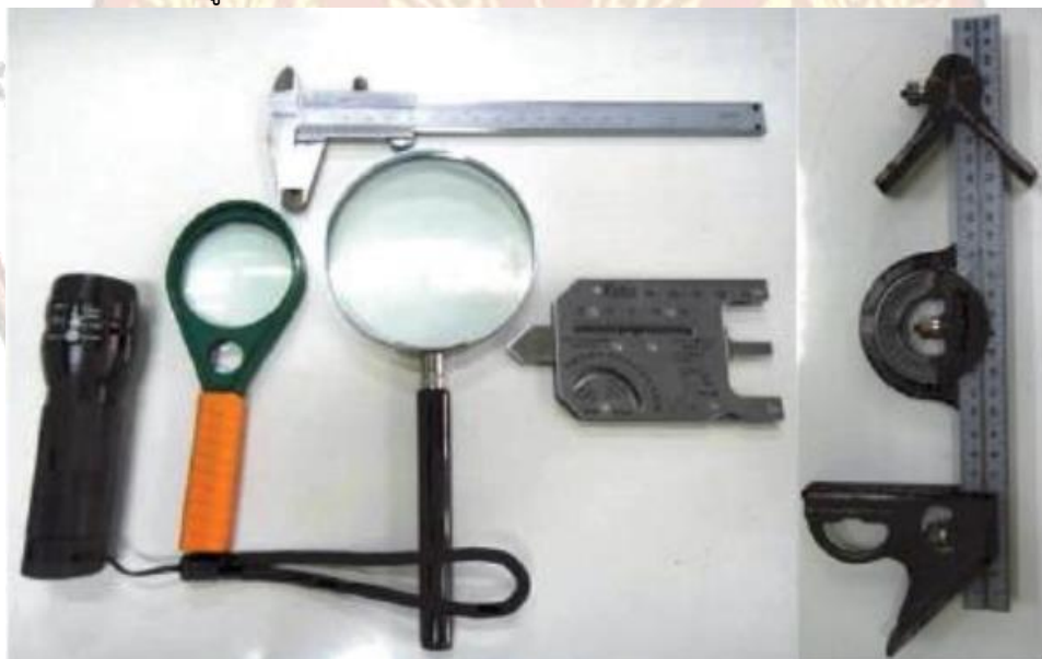
รูปที่ ๔.๑ แสดงลักษณะอุปกรณ์การตรวจสอบงานเชื่อมด้วยการพินิจ
