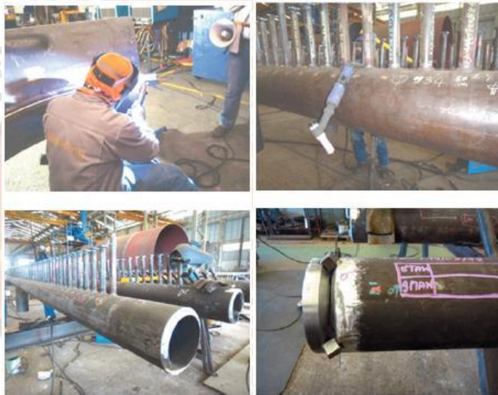
รูปที่ ๔.๑๕ แสดงลักษณะงานเชื่อมเหล็กกล้าคาร์บอนด้วยการเชื่อมอาร์กทั้งสแตนแก๊สคลุม
