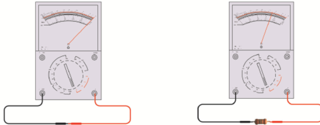
(ก) การปรับแต่งโอห์มมิเตอร์ก่อนการใช้งาน (ข) การใช้โอห์มมิเตอร์วัดค่าความต้านทาน
