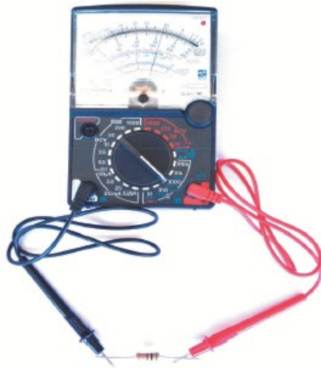
รูปที่ 2.13 ตัวอย่างการวัดความต้านทานด้วยมัลติมิเตอร์
