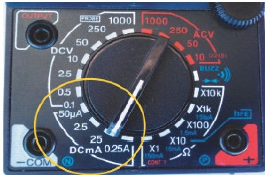
รูปที่ 2.9 ย่านวัด DCmA ของมัลติมิเตอร์ยี่ห้อ YX-360TRE-B
