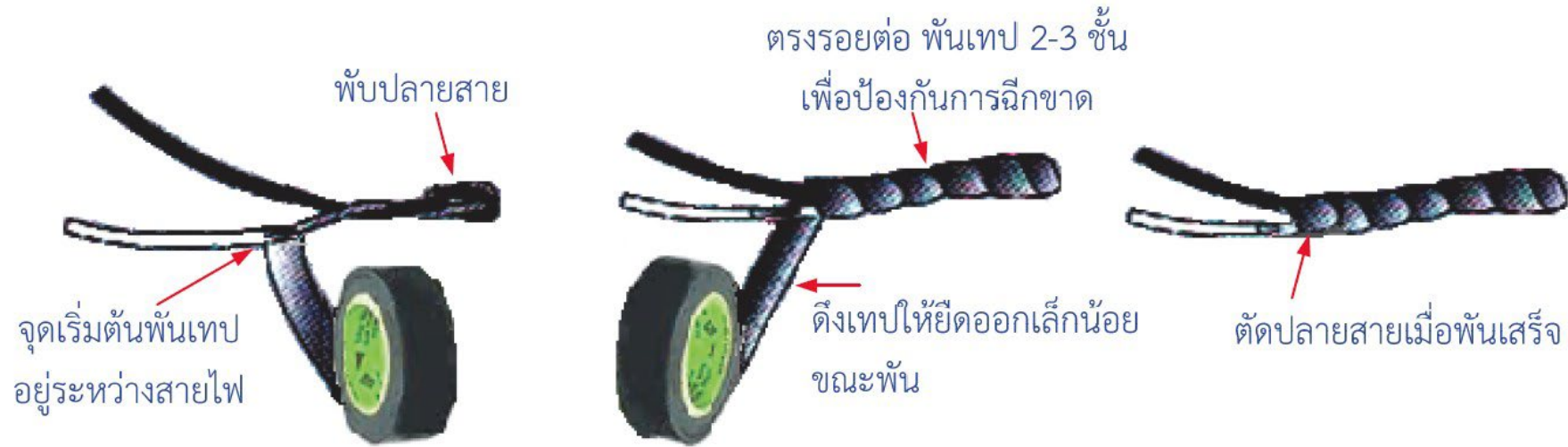
ข) การใช้เทปพันสายไฟพันรอยต่อสายไฟฟ้า
