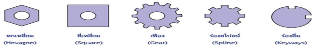
รูปที่ 2.25 ลักษณะชิ้นงานที่ใช้อุปกรณ์จับยึดแบบหัวแปง (Indexing Fixture)
