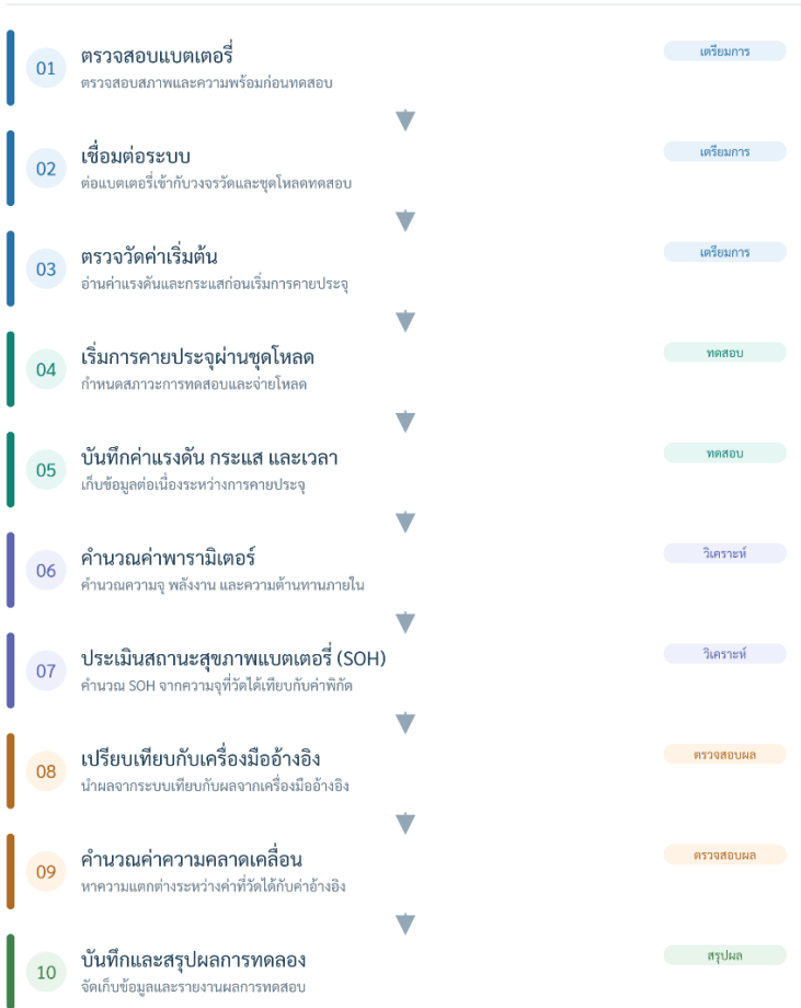
ภาพที่ 3.10 แผนภาพลำดับขั้นตอนการทดสอบเครื่องวิเคราะห์สุขภาพแบตเตอรี่
