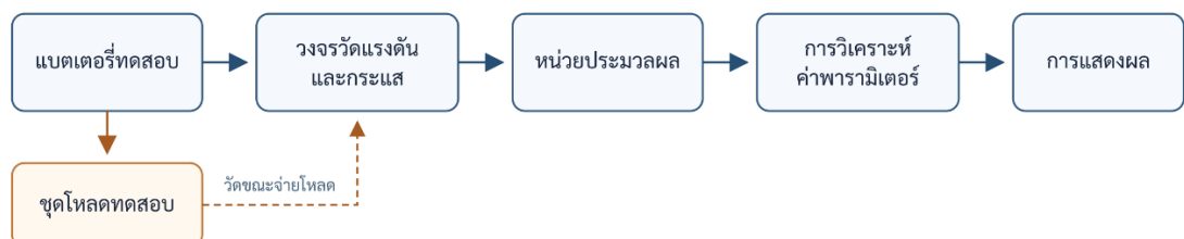
ภาพที่ 3.1 แผนภาพบล็อกการทำงานของเครื่องวิเคราะห์สุขภาพแบตเตอรี่
