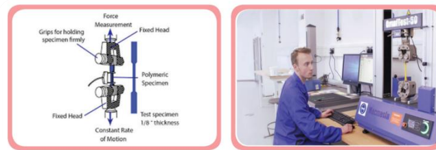
ภาพที่ 11.7 ลักษณะการทดสอบแรงดึง
