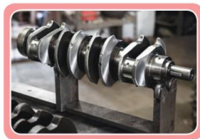
ภาพที่ 3.19 ชิ้นส่วนของเครื่องยนต์ ทำจากเหล็กหล่อกราไฟต์กลม
