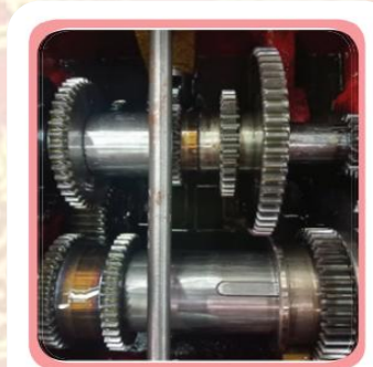
ภาพที่ 3.9 ชุดเฟืองหัวเครื่องกลึงทำจากเหล็กกล้าประสมต่ำ
