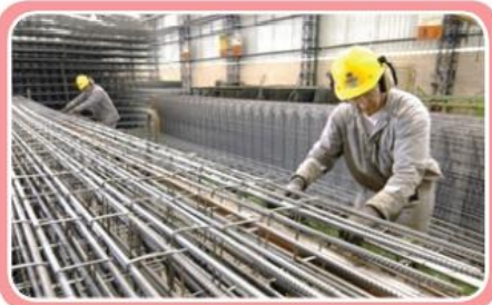
ภาพที่ 3.1 เหล็กเส้นในอุตสาหกรรมก่อสร้าง ทำจากเหล็กกล้าคาร์บอนต่ำ
