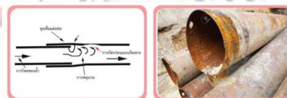
ภาพที่ 10.6 ลักษณะของการกัดกร่อนแบบกัดเซาะในท่อ
