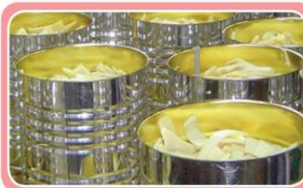
ภาพที่ 3.3 กระป๋องบรรจุอาหารทำจาก เหล็กกล้าคาร์บอนต่ำ
