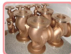
ภาพที่ 4.41 ลักษณะชิ้นงานทำจากทองแดงหล่อ
