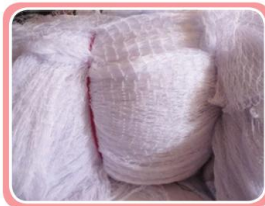
ภาพที่ 8.5 อวน และเส้นด้ายโนลอน ทำมาจากโพลีเอไมต์ หรือโนลอน
