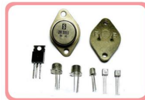
ภาพที่ 9.23 ลักษณะของทรานซิสเตอร์แบบต่าง ๆ และการใช้งานวงจรไฟฟ้
