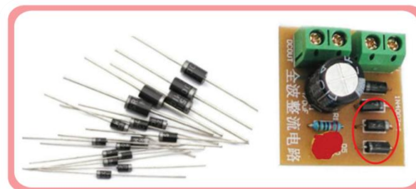
ภาพที่ 9.12 ลักษณะของไดโอด และการใช้งานวงจรอิเล็กทรอนิกส์
