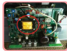
ภาพที่ 9.27 ลักษณะของหม้อแปลง และการใช้งานวงจรอิเล็กทรอนิกส์
