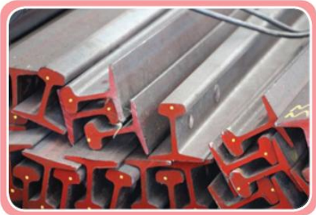
ภาพที่ 3.4 รางรถไฟทำจากเหล็กกล้าคาร์บอนปานกลาง
