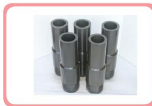
ภาพที่ 10.12 ตัวอย่างชิ้นงานจากสังกะสี และเหล็กชุบฟอสเฟต
