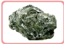
ภาพที่ 4.24 ลักษณะของแร่โมลิบดีไนต์ และตัวอย่างเหล็กโรสซึมที่ผสมโมลิบดีนัม
