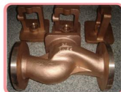
ภาพที่ 4.41 ลักษณะชิ้นงานทำจากทองแดงหล่อ
