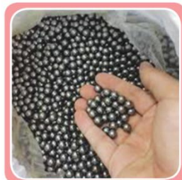
ภาพที่ 3.15 ลูกบอลกลมในบรรจุภัณฑ์ ทำจากเหล็กหล่อสีขาว
