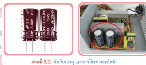
ภาพที่ 9.21 ตัวเก็บประจุ และการใช้งานวงจรไฟฟ้า
