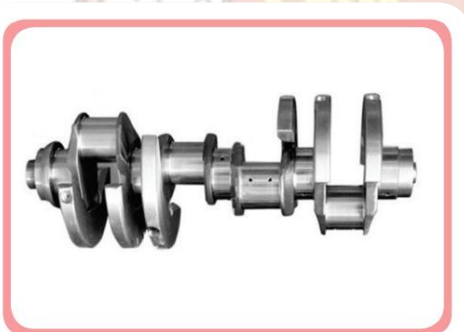
ภาพที่ 3.8 เฟลาข้อเหวี่ยงทำจากเหล็กกล้าประสมต่ำ
