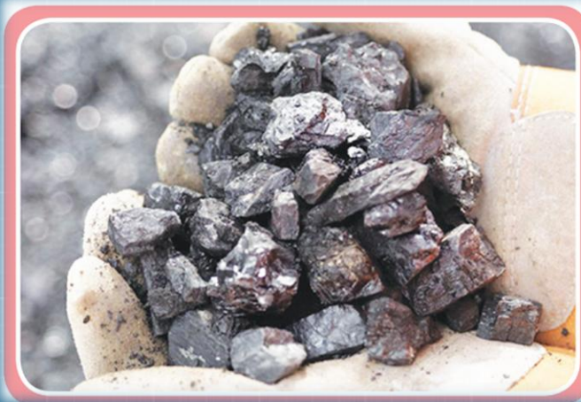
ภาพที่ 1.2 วัตถุดิบสินแร่เหล็กถูกนำมาผ่านกระบวนการหลอมเป็นแท่งเหล็ก
