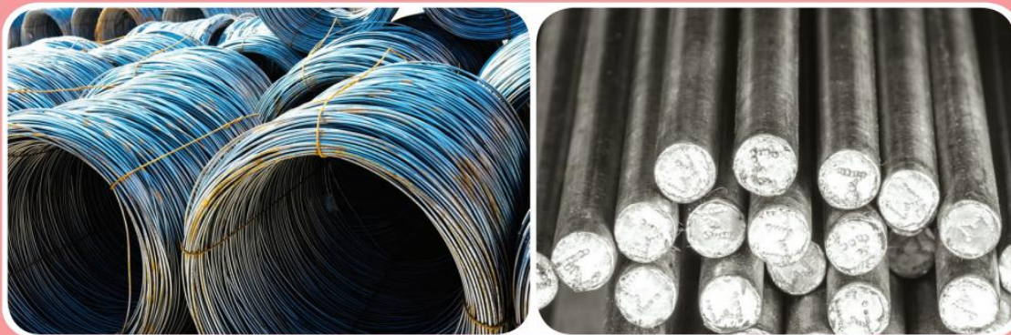
ภาพที่ 2.26 มาตรฐานเหล็กเส้นกลม มีชั้นคุณภาพ SR24
