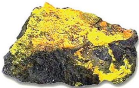
ภาพที่ 4.26 ลักษณะของแร่พิตช์เบลนด์ (Pitch Blende) สำหรับถลุงแร่ยูเรเนียม
