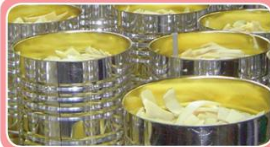
ภาพที่ 3.3 กระป๋องบรรจุอาหารทำจาก เหล็กกล้าคาร์บอนต่ำ
