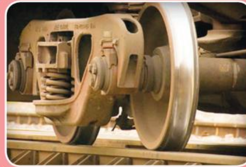
ภาพที่ 3.16 ล้อรถไฟทำจากเหล็กหล่อสีขาว
