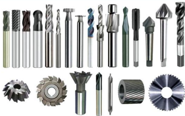
ภาพที่ 3.11 เครื่องมือตัดในงานเครื่องมือกลทำจากเหล็กกล้าความเร็วสูง
