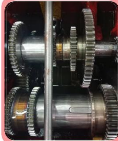
ภาพที่ 3.9 ชุดเฟืองหัวเครื่องกลึงทำจากเหล็กกล้าประสมต่ำ
