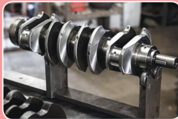
ภาพที่ 3.19 ชิ้นส่วนของเครื่องยนต์ ทำจากเหล็กหล่อกราไฟต์กลม
