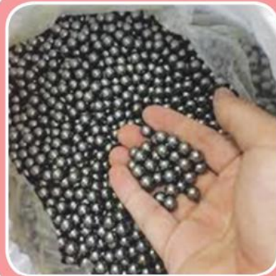
ภาพที่ 3.15 ลูกบอลกลมในเบร้งลูกปืน ทำจากเหล็กหล่อสีขาว
