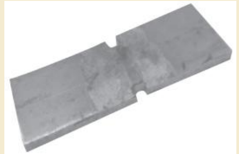
ลักษณะการเตรียมชิ้นงานทดสอบ งานเชื่อมต่อน
