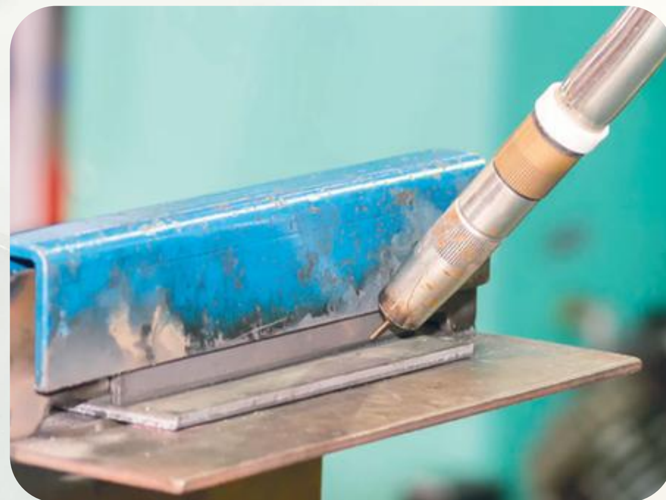
ระยะที่ลวดเชื่อม พ้นออกมาจากหัวเชื่อม
