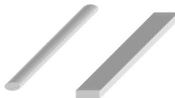
ภาพที่ 4 : ลักษณะรูปร่างของชิ้นทดสอบแรงดึง
