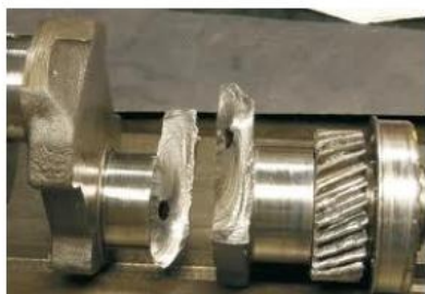
รูปที่ 1 (ซ้าย) การแตกหักของเพลาคอเหวี่ยง และ (ขวา) การแตกหักของเสารับน้ำหนัก
