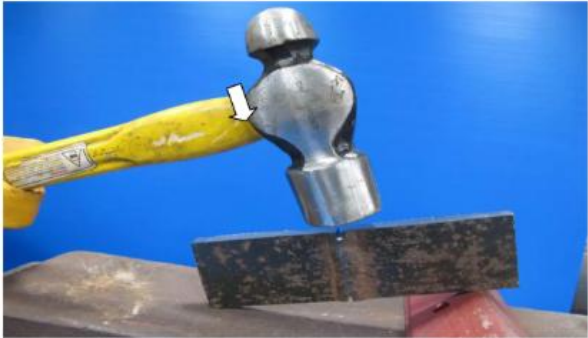
รูปที่ 2.3-1 แสดงปากกาจับยึดชิ้นงานตั้งโต๊ะ ในกรณีตีหักด้วยค้อน (Hammer)
