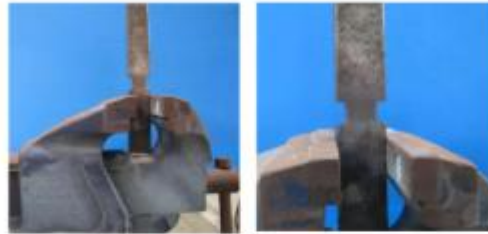
รูปที่ 2.3-6 แสดงการทดสอบตีหักแนวเชื่อมด้วยค้อน
