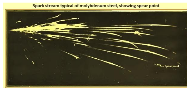
รูปที่ 3 กระแสประกายไฟแบบทั่วไปของเหล็กโมลิบดีนัม
