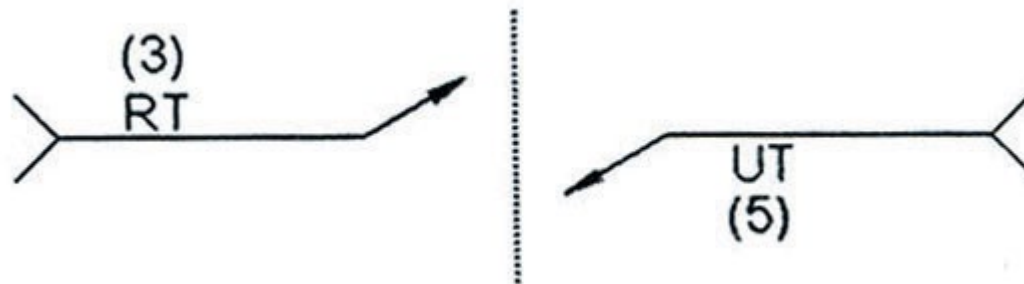
รูปที่ 4.15 การกำหนดจำนวนของการตรวจสอบโดยไม่ทำลาย
