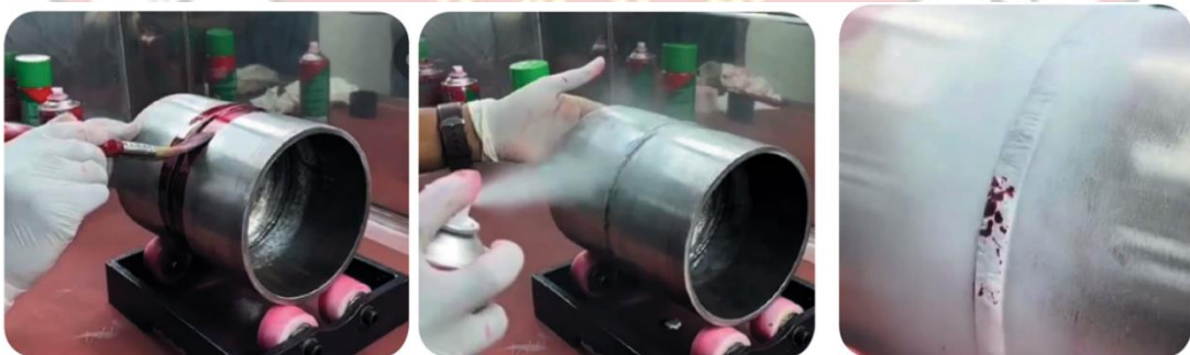
รูปที่ 9.12 แสดงการตรวจสอบข้อบกพร่องด้วยน้ำยาแทรกซึม
