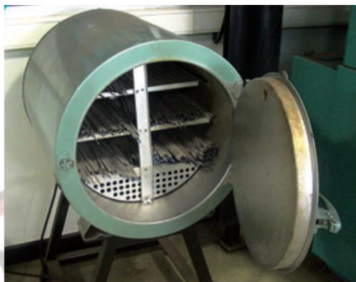
รูปที่ 9.6 แสดงการอบไล่ความชื้นลวดเชื่อม
