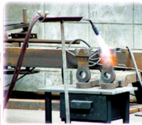
รูปที่ 9.4 แสดงตัวอย่างการอุ่นชิ้นงาน
