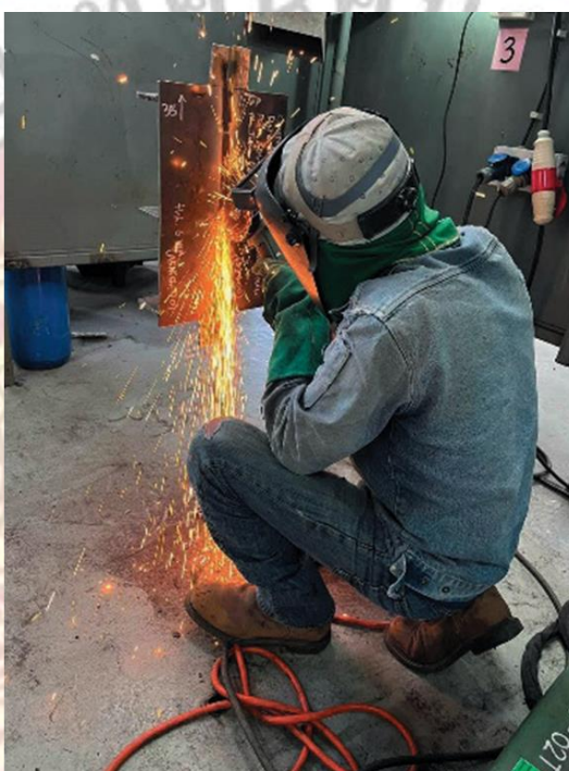
รูปที่ 8.9 แสดงสภาพการทำความสะอาดงานเชื่อม
