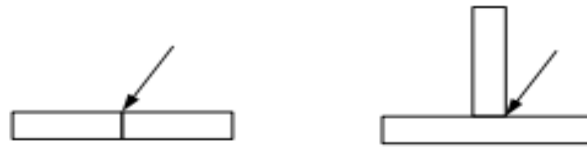
ภาพที่ 7.2 การกำหนดเส้นลูกศรชี้ตำแหน่งแนวเชื่อม
