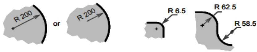
รูปที่ ๖ การบอกขนาดของส่วนโค้ง [๑] รูปที่ ๗ การบอกขนาดของราวต์และฟิลเลต [๑]
