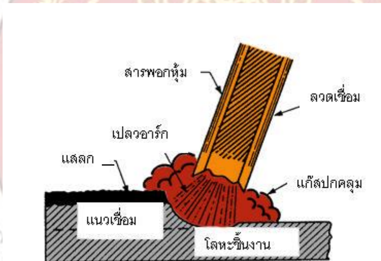
รูปที่ ๕.๔๘ แสดงการเชื่อมไฟฟ้าด้วยลวดเชื่อมหุ้มฟลักซ์
