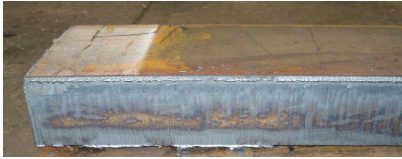
รูปที่ ๔.๑๑ แสดงลักษณะรอยตัดที่ดีผิวจะต้องเรียบสม่ำเสมอ
