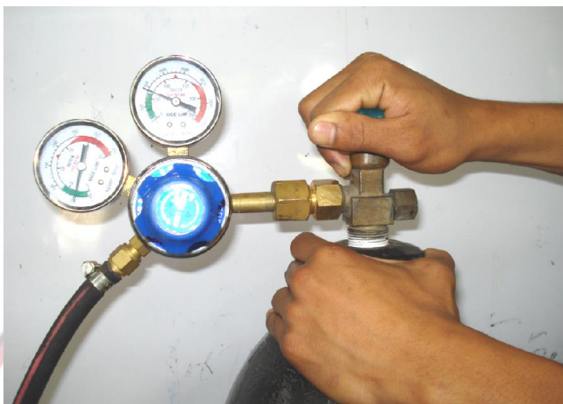
รูปที่ ๑.๒๓ แสดงการเปิดวาล์วถังแก๊สออกซิเจน
