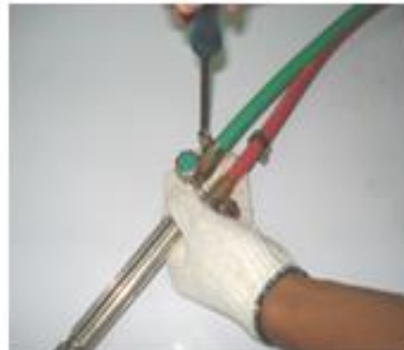
รูปที่ ๑.๓๘ แสดงรูปสายเชื่อมแก๊สที่ต่อเกลียวเข้ากับท่อแก๊สและหัวเชื่อม
