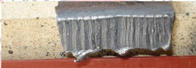
รูปที่ ๔.๑๒ แสดงลักษณะรอยตัดที่ไม่ดี หัวทิพสกปรก และการผสมของแก๊สไม่เหมาะสม
