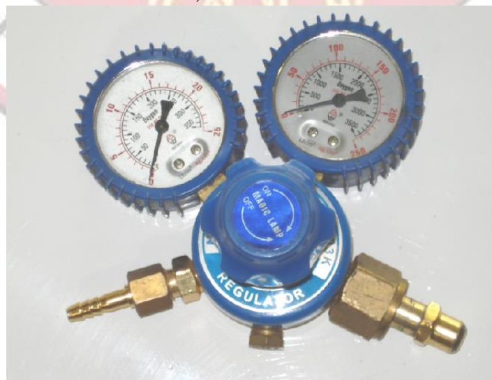
รูปที่ ๑.๓๑ แสดงลักษณะหลักการทำงานของหัวปรับความดันแบบสองขั้น ที่มา : นริศ ศรีเมฆ,พิชัย โอภาสอนันต์. ๒๕๔๓ : ๓๔
