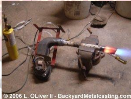
รูปที่ ๓.๑๕ แสดงเปลวแก๊ส MAPP กับออกซิเจน ในการเล่นประสาน
