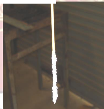
(ค) ฟลักซ์เกาะติดลวดขึ้นมา
