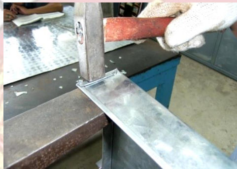
รูปที่ 8.13 แสดงการพับตะเข็บมุมสองชั้นงานถาดเก็บ
