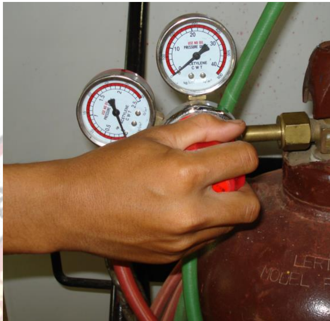
รูปที่ ๑.๑๑ แสดงการปรับความดันแก๊สให้เหมาะสมกับการใช้งาน
