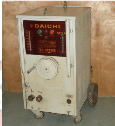
รูปที่ ๕.๑๖ แสดงรูปเครื่องเชื่อมแบบหม้อแปลงต่อแยกออกมาจากขดลวดทุติยภูมิ
