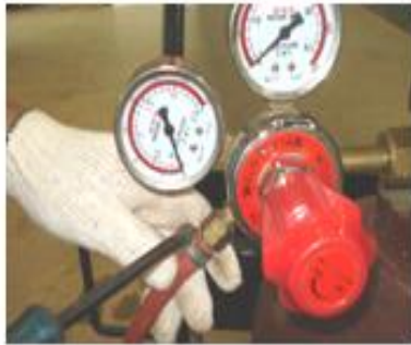
รูปที่ ๑.๓๘ แสดงรูปสายเชื่อมแก๊สที่ต่อเกลียวเข้ากับท่อแก๊สและหัวเชื่อม
