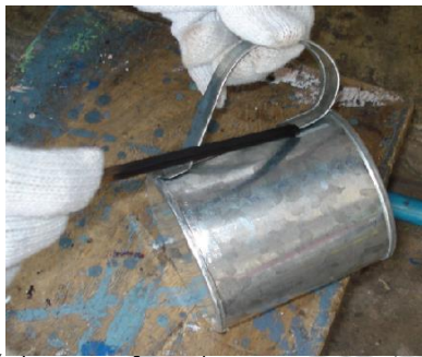
(ก) การทาน้ำยาประสานบนรอยต่องาน
