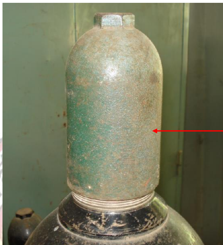
รูปที่ ๑.๑๙ แสดงรูปฝาครอบที่หัวถังแก๊สออกซิเจนโดยใช้เกลียวหมุน
