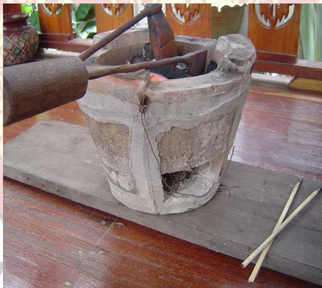
รูปที่ ๙.๑๑ แสดงการเผาให้ความร้อนหัวบัดกรีในเตา
