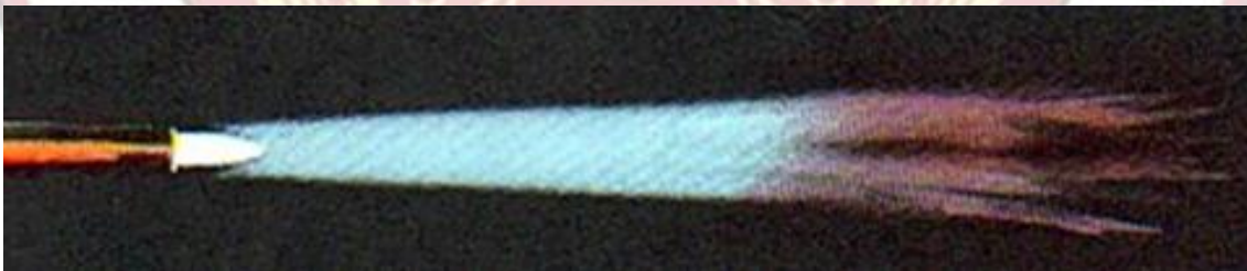
รูปที่ ๑.๔๘ แสดงเปลวออกซิไดซิง (Oxidizing Flame) ที่มา : ALTHOUSE,TURNQUIST,BOWDITCH. ๑๙๘๐ : ๒๙
