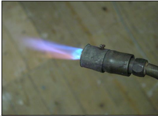
รูปที่ ๓.๑๖ แสดงเปลวแก๊สโพรเพน กับออกซิเจน ในการเล่นประสาน ที่มา : content.answers.com
