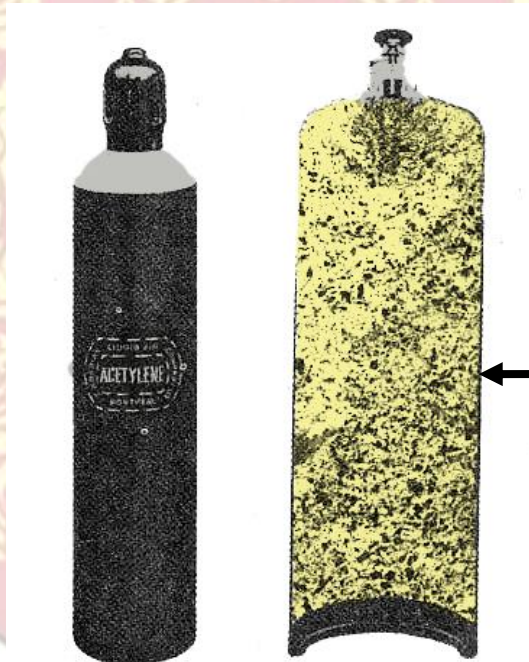
รูปที่ ๑.๒๙ แสดงลักษณะภายในของถังแก๊สอะเซทิลีน
