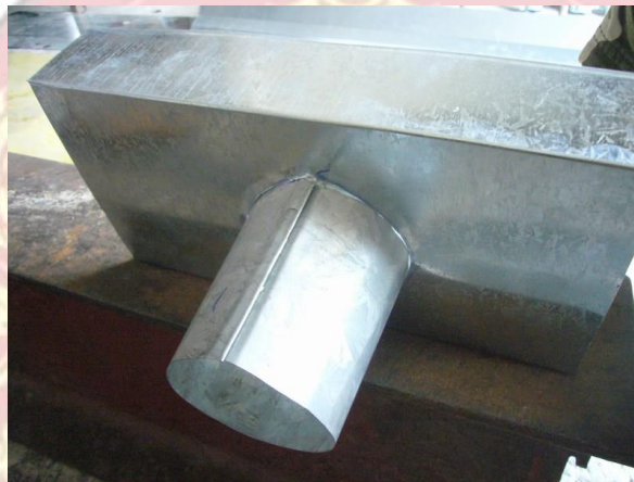
รูปที่ ๙.๑๗ แสดงการประกอบชิ้นงานรางน้ำด้วยการบัดกรี
