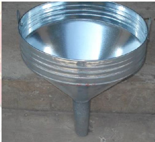
รูปที่ 7.8 แสดงงานผลิตภัณฑ์ที่ใช้หลักการเขียนแบบแผ่นคลี่ด้วยวิธีเส้นรัศมี
