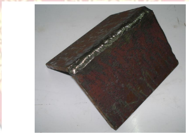
รูปที่ ๕.๕๒ แสดงลักษณะมุมลวดเชื่อมในการต่อมุมท่าระดับ
