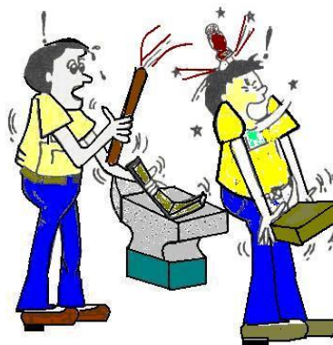
รูปที่ 6.9 แสดงอุบัติเหตุจากการใช้ค้อนชำรุด
