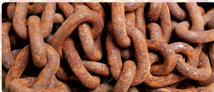
รูปที่ 5.9 การกัดกร่อนแบบสม่ำเสมอ
