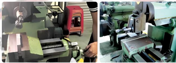
(ก) การไสแบบมิตเคลื่อนที่ (ข) การไสแบบชิ้นงานเคลื่อนที่ รูปที่ 2.12 ลักษณะการไสแบบมิตเคลื่อนที่และชิ้นงานเคลื่อนที่
