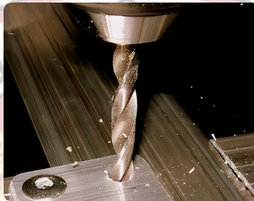
รูปที่ 2.15 ลักษณะการทำงานของเครื่องเจาะ
