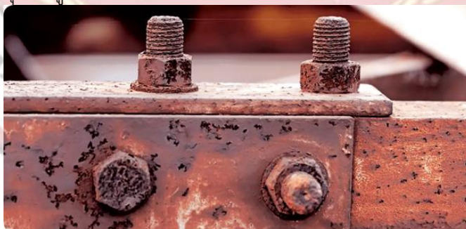
รูปที่ 5.10 การกัดกร่อนเนื่องจากความต่างศักย์
