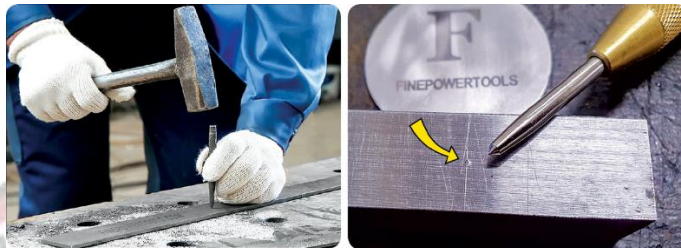
รูปที่ 4.17 การตอกเหล็กนำศูนย์
