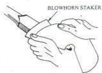
การใช้มือกดขึ้นรูปกรวยด้วย Blowhorn Stake
