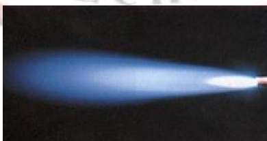
รูปที่ 3.4 ลักษณะเปลวคาร์บูไรซิงหรือเปลวลด
