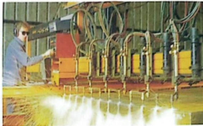
ภาพที่ 5.14 การตัดโลหะด้วยแก๊สโดยใช้คอมพิวเตอร์ควบคุม
