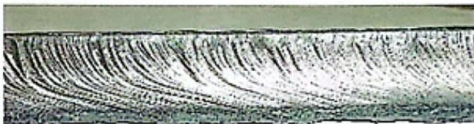
ภาพที่ 5.22 ลักษณะของรอยตัดที่ใช้ความเร็วในการตัดสูงเกินไป
