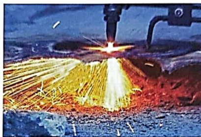
ภาพที่ 5.9 การตัดโลหะด้วยแก๊ส ที่มา: http://www.bigstockphoto.com/th/image-5654940/stock-photo-gas-cutting
