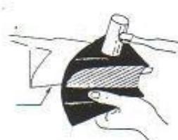
การใช้ค้อนเคาะขึ้นรูปชิ้นงานด้วย Blowhorn Stake
