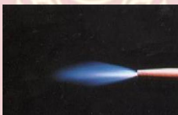
รูปที่ 3.5 ลักษณะเปลวออกซิไดซิงหรือเปลวเพิ่ม
