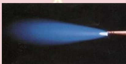
รูปที่3.3 ลักษณะเปลวนิวทรัลหรือเปลวกลาง
