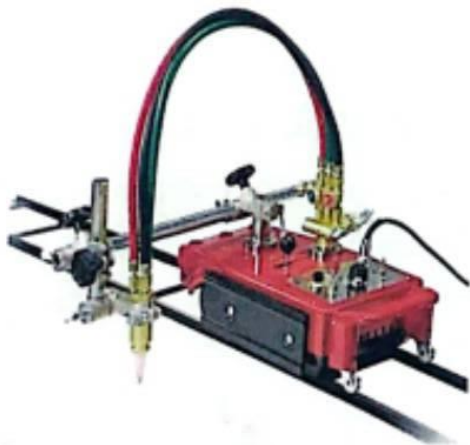
ภาพที่ 5.15 เครื่องตัดแก๊สชนิดเดินตามราง
