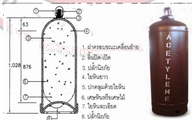
รูปที่ 3.9 ลักษณะภายในของถังแก๊สอะเซทิลีน
