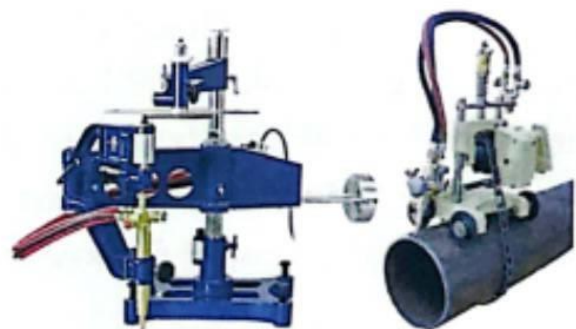
ภาพที่ 5.16 เครื่องตัดแก๊สชนิดเดินตามแบบ และแบบชนิดตัดท่อ
