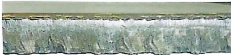
ภาพที่ 5.23 ลักษณะของรอยตัดที่ใช้ระยะห่างของกรวยไฟกับชิ้นงานไม่เหมาะสม ที่มา: http://www4.hcmut.edu.vn/~dantn/TWI/jk50.html
