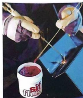
ภาพที่ 5.8 การอุ่นลวดเล่นประสาน แล้วจุ่มผงฟลักซ์ ที่มา: https://www.cromwell.co.uk/shop/010105/brazing-rods
