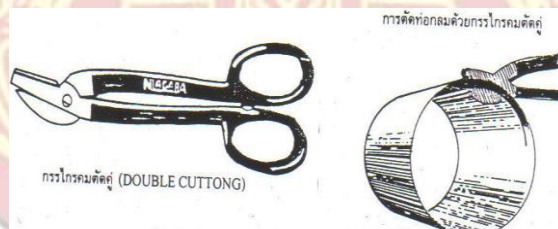
รูปที่ 6.33 รูปร่างของกรรไกรคมตัดคู่ และการใช้งาน
