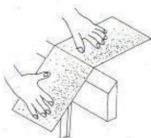
การใช้มือกดพับชิ้นงานด้วย Hatchet Stake
