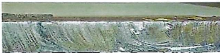
ภาพที่ 5.24 ลักษณะของรอยตัดที่ใช้แรงดันของออกซิเจนตัดไม่เหมาะสม ที่มา: http://www.hcmut.edu.vn/~dantn/TWI/jk50.html
