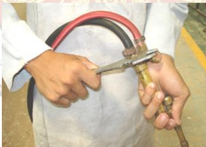
รูปที่ ๑.๒๔ แสดงการประกอบสายเชื่อมแก๊สต่อเข้ากับหัวเชื่อมแก๊ส
