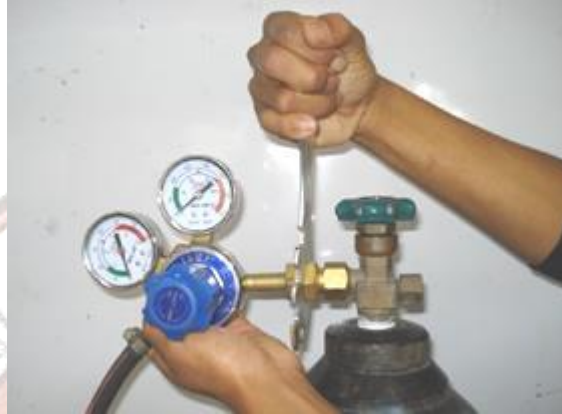
รูปที่ ๑.๒๑ แสดงการประกอบเครื่องควบคุมความดันถังแก๊สออกซิเจน
