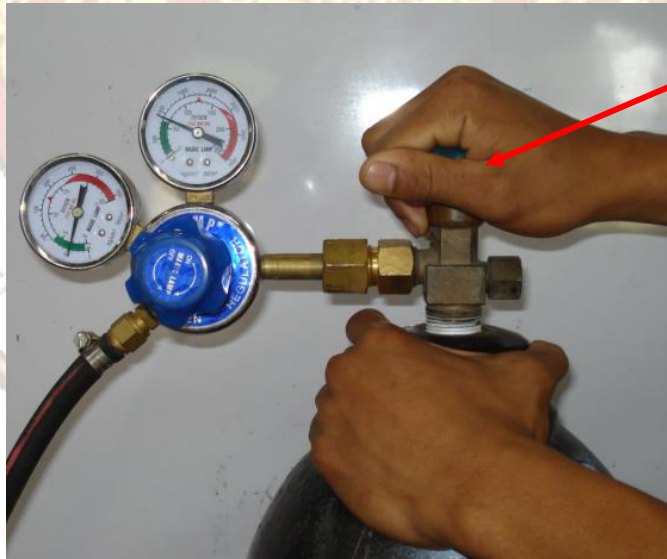
รูปที่ ๑.๑๐ แสดงการเปิด/ปิด ล้วนหัวถัง (แก๊สออกซิเจน)
