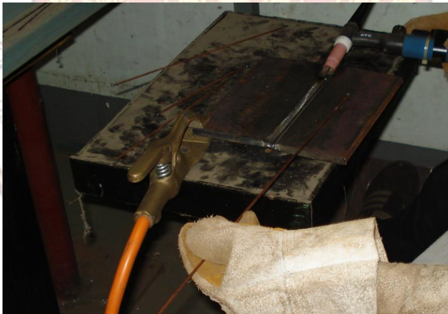
รูปที่ ๕.๑๒ แสดงการขันข้อต่อสายดินให้แน่น
