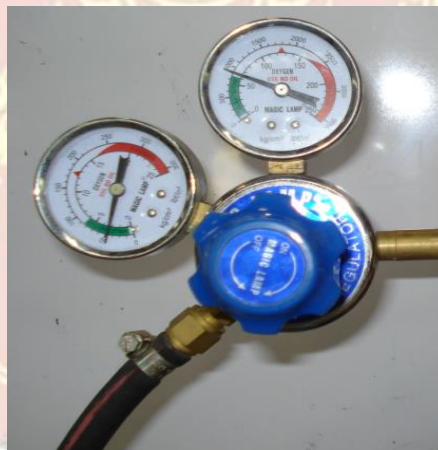
รูปที่ ๑.๑๒ แสดงการใช้เข็มขัดรัดสายแก๊สกับข้อต่อ
