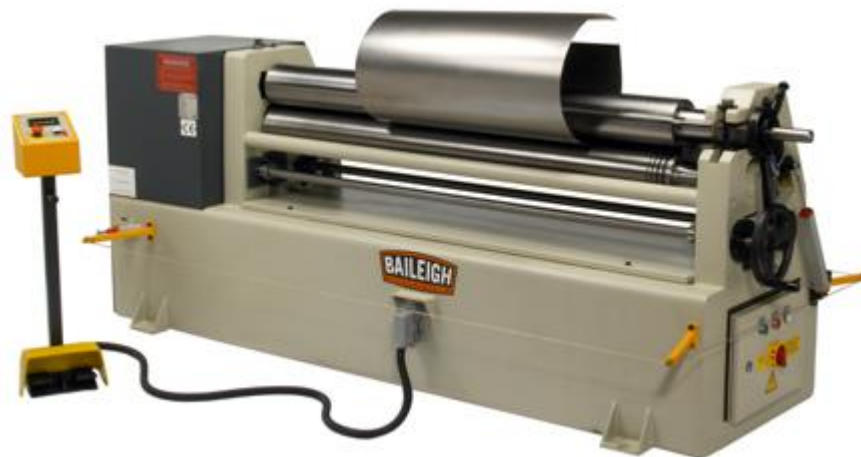
รูปที่ ๘.๒๒ แสดงลักษณะการทำงานของเครื่องม้วนชนิดใช้แรงหมุนด้วยมอเตอร์ไฟฟ้า ที่มา : www.bii๑.com
