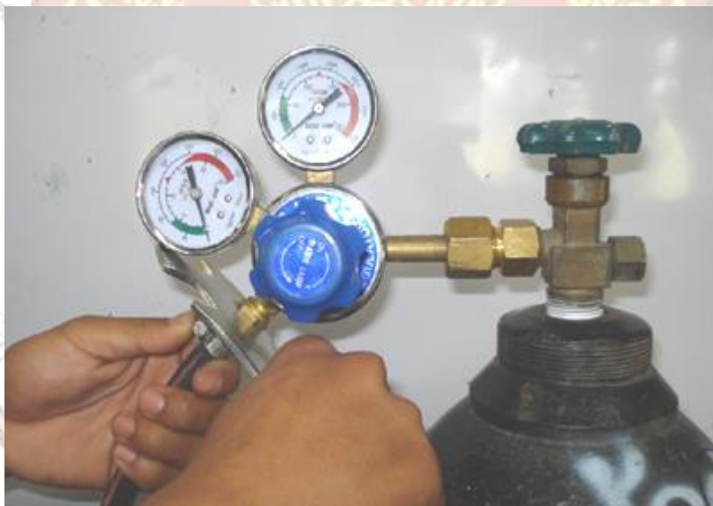
รูปที่ ๑.๒๒ แสดงการประกอบสายเชื่อมเข้ากับเครื่องควบคุมความดันแก๊สออกซิเจน
