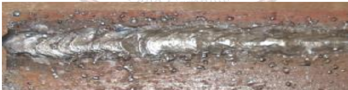
รูปที่ ๕.๔๒ แสดงแนวเชื่อมที่ใช้กระแสไฟฟ้าสูง
