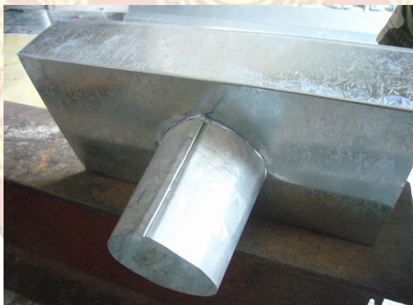
รูปที่ ๙.๑๗ แสดงการประกอบชิ้นงานรางนาด้วยการบัดกรี
