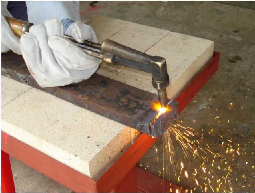
รูปที่ ๔.๑ แสดงการตัดโลหะด้วยแก๊ส
