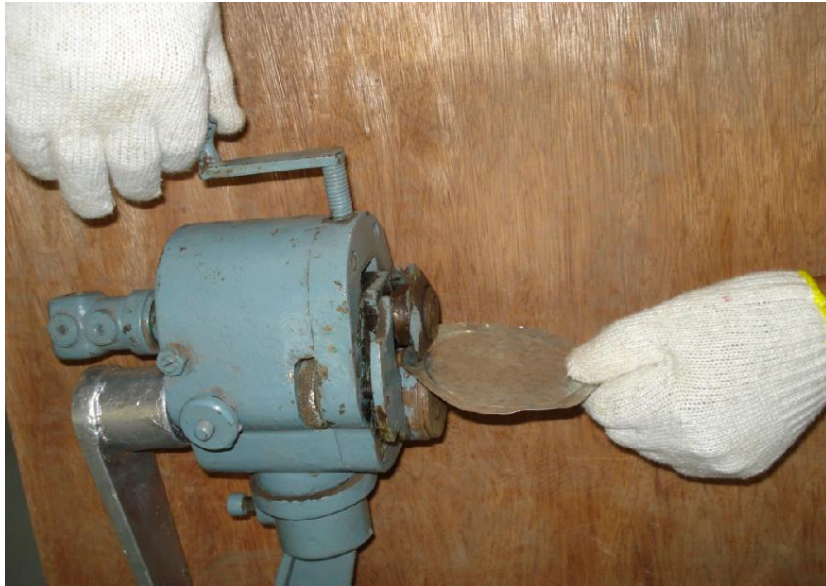
รูปที่ ๘.๑๘ แสดงการขึ้นขอบชิ้นงานแผ่นกลม
