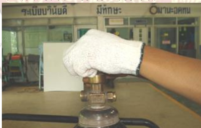
รูปที่ ๑.๒๐ แสดงการเปิดวาล์วหัวถังแก๊สออกซิเจนที่ถูกต้อง
