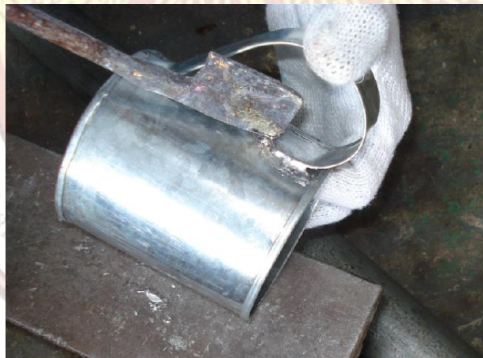
รูปที่ ๙.๑๕ แสดงการบัดกรีขอบตะเข็บ
