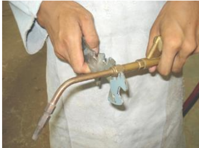
รูปที่ ๑.๒๕ แสดงการประกอบหัวเชื่อมแก๊สและหัวทิพ
