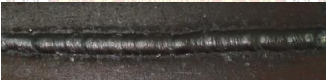
รูปที่ ๕.๔๑ แสดงแนวเชื่อมที่ใช้กระแสไฟฟ้าต่ำ
