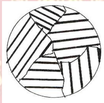
รูปที่ 9 แสดงโครงสร้างยูเทคติก
