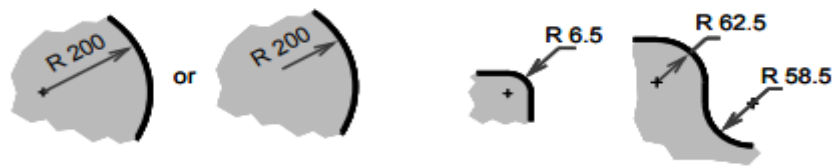
รูปที่ ๖ การบอกขนาดของส่วนโค้ง [๑] รูปที่ ๗ การบอกขนาดของราวต์และฟิเลต [๑]
