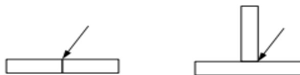
ภาพที่ 7.2 การกำหนดเส้นอุทธรชี้ตำแหน่งแนวเชื่อม
